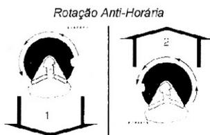
**3- Rebote:** Ocorre quando se toca algum objeto / material duro com a parte frontal do equipamento. Esta força fará com que o equipamento se mova abruptamente / violentamente para a direita. Este movimento é perigoso uma vez que o movimento é repentino e pode resultar na perda do controle do equipamento.
